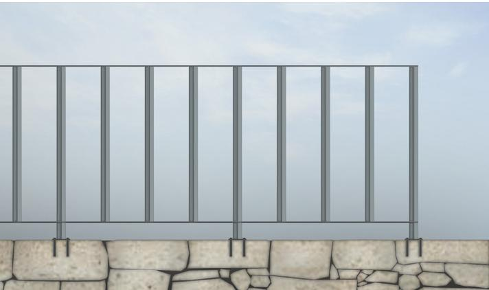
Guarda metálica com dimensões, material e cor igual ao existente, fixo em pedra de granito - pormenor de construção.
