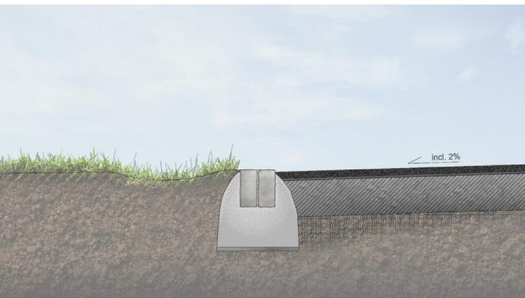
Transição entre área verde e pavimento em betuminoso IRR, frio, colorido, tipo "NEOASFALTO" ou equivalente - pormenor de construção.
