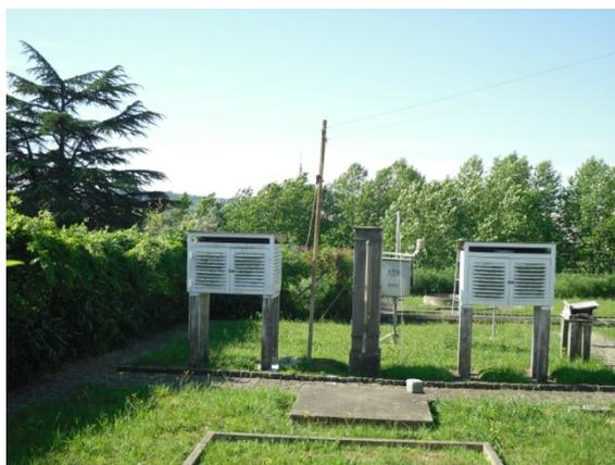
Fig.53 – Estação Meteorológica Automática (EMA).
