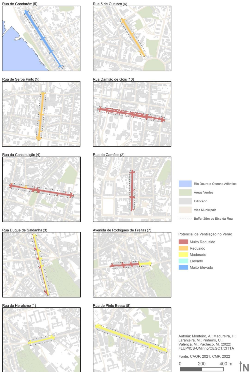
Figura 3.12 - Potencial de ventilação no Verão nas ruas-protótipo.
