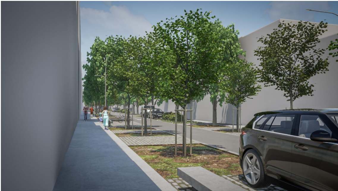
Figura 6.5 - Vista a partir do passeio do lado nascente da rua: espaço pedonal com bandas de pavimento liso (circulação universal) e zona de estadia/ de sentar que tira partido do espaço da arborização; espaço da arborização com alinhamentos laterais de árvores existentes de copa média-larga e de árvores propostas de copa média-estreita em faixa contínua (com bordadura mista de subarbustos e herbáceas vivazes); espaço viário com uma via de trânsito (sentido norte-sul) e zona de estacionamento que tira partido do espaço da arborização.
