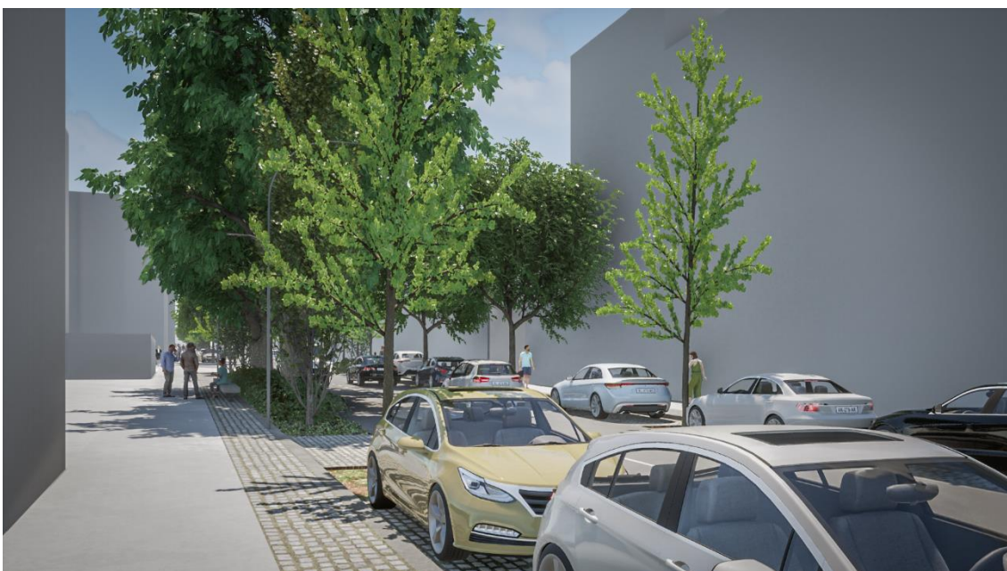
Figura 8.8 - Vista a partir do passeio do lado nascente da rua: espaço pedonal com bandas de pavimento rugoso e liso (circulação universal); espaço da arborização com composição de árvores de copa média-estreita e árvores de copa média-larga em faixa contínua (com bordadura mista de subarbustos e herbáceas vivazes); espaço viário com duas vias de trânsito (dois sentidos) e zona de estacionamento que tira partido do espaço da arborização.
