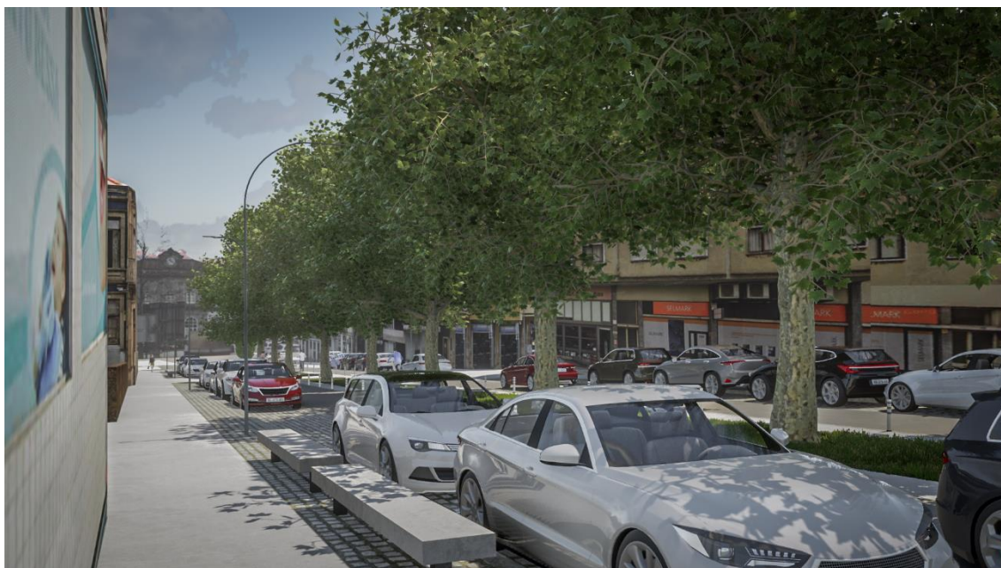
Figura 11.4 - Vista a partir do passeio do lado nascente da rua: espaço pedonal com bandas de pavimento rugoso e liso (circulação universal) e zona de estadia/ de sentar; espaço viário com uma via de trânsito, ciclovia e zona de estacionamento, de cada lado do espaço da arborização; espaço da arborização com alinhamento central de árvores de copa muito larga, em faixa contínua.
