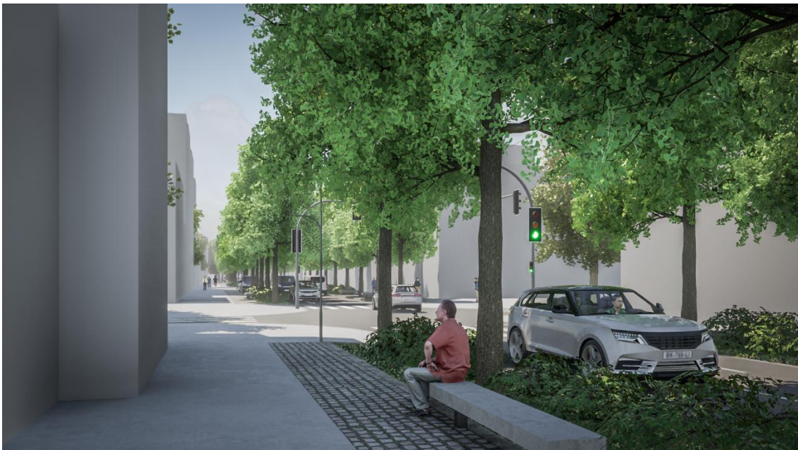
Figura 10.9 - Vista a partir do passeio do lado sul da rua: espaço pedonal com bandas de pavimento rugoso e liso (circulação universal) e zona de estadia/de sentar; espaço da arborização com alinhamentos laterais de árvores de copa média-larga em faixa contínua (com bordadura mista de subarbustos e herbáceas vivazes); espaço viário com duas vias de trânsito (dois sentidos).
