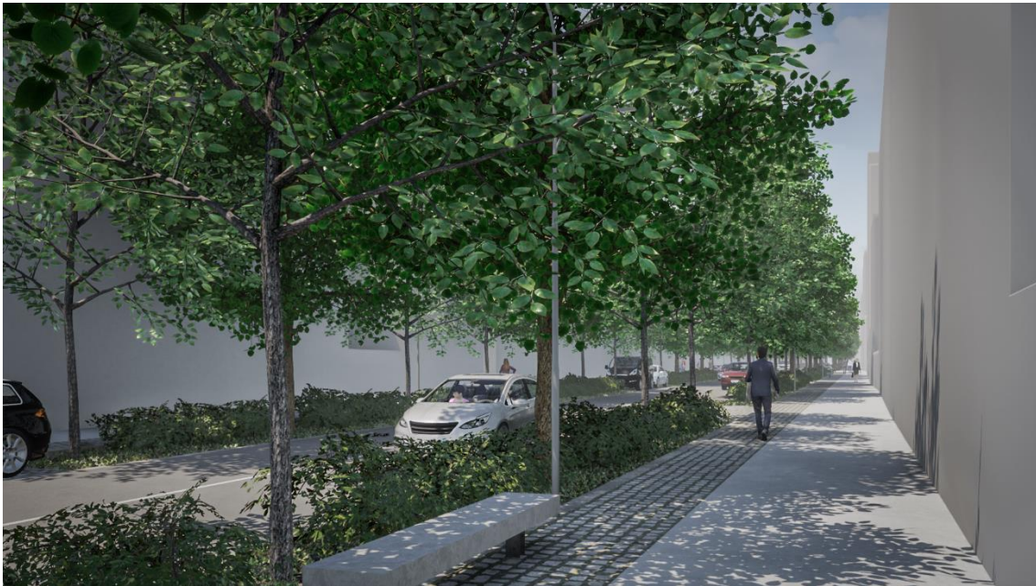
Figura 9.5 - Vista do passeio do lado poente da rua: espaço pedonal com bandas de pavimento rugoso e liso (circulação universal) e zona de estadia/de sentar; espaço da arborização com alinhamentos laterais de árvores de copa média-larga em faixa contínua (com bordadura mista de subarbustos e herbáceas vivazes); espaço viário com duas vias de trânsito (sentido noroeste-sudeste).
