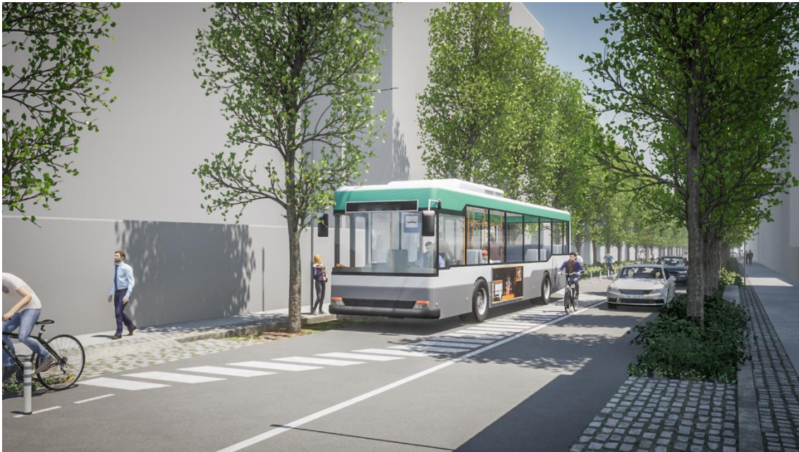
Figura 7.5 - Vista a partir do espaço de arborização do lado sul da rua: espaço da arborização com alinhamentos laterais de árvores de copa média-estreita em caldeira e em faixa contínua (com bordadura mista de subarbustos e herbáceas vivazes); espaço viário com duas vias de trânsito e uma ciclovia (sentido nascente-poente); espaço pedonal com bandas de pavimento rugoso e liso (circulação universal).
