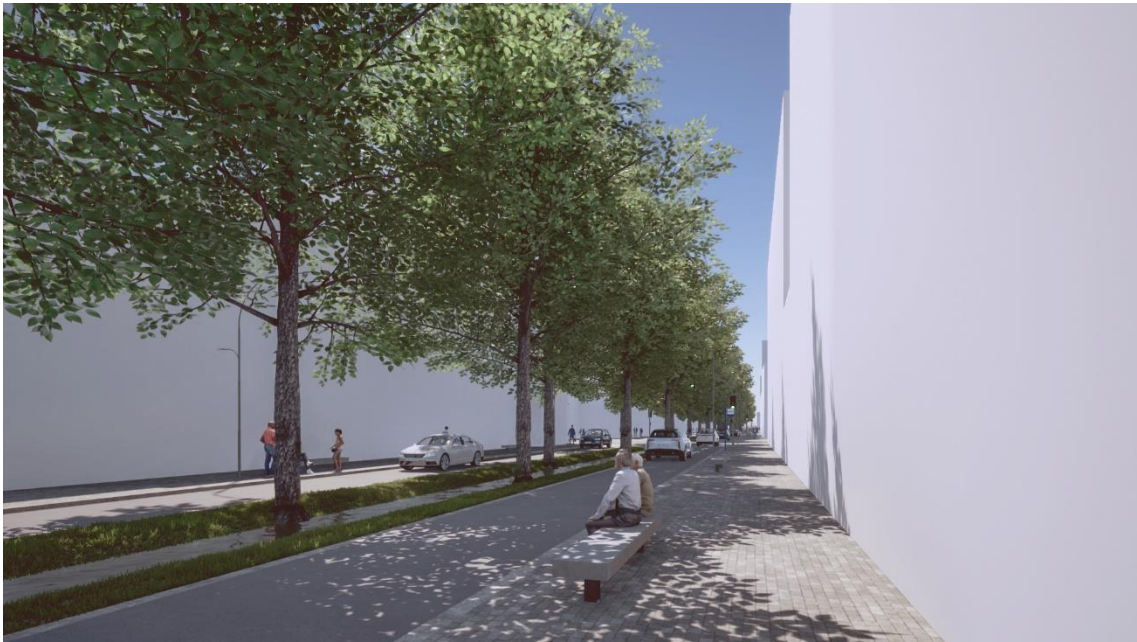
Figura 10.5 - Vista a partir do passeio do lado norte da rua: espaço pedonal com pavimento rugoso e zona de estadia/de sentar que tira partido do espaço da arborização; espaço viário com uma via de trânsito, de cada lado do espaço da arborização; espaço da arborização com alinhamento central de árvores de copa muito larga em faixa contínua.
