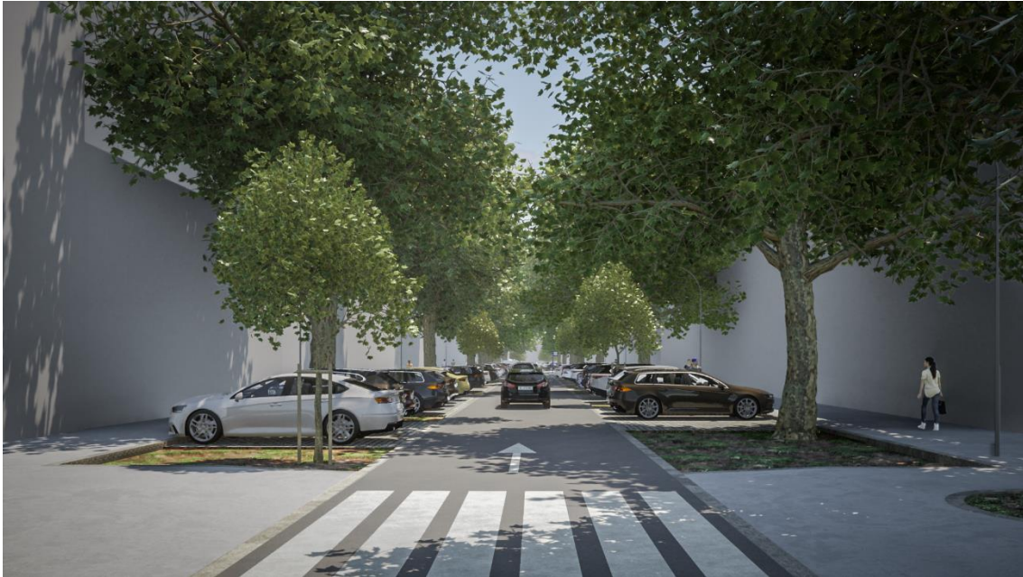
Figura 12.5 - Vista a partir do eixo da rua: espaço viário com uma via de trânsito (sentido norte-sul) e zona de estacionamento que tira partido do espaço da arborização; espaço da arborização com alinhamentos laterais de árvores de copa muito larga, propostas e existentes ( Platanus x acerifolia ), em caldeira; espaço pedonal com bandas de pavimento liso (circulação universal).
