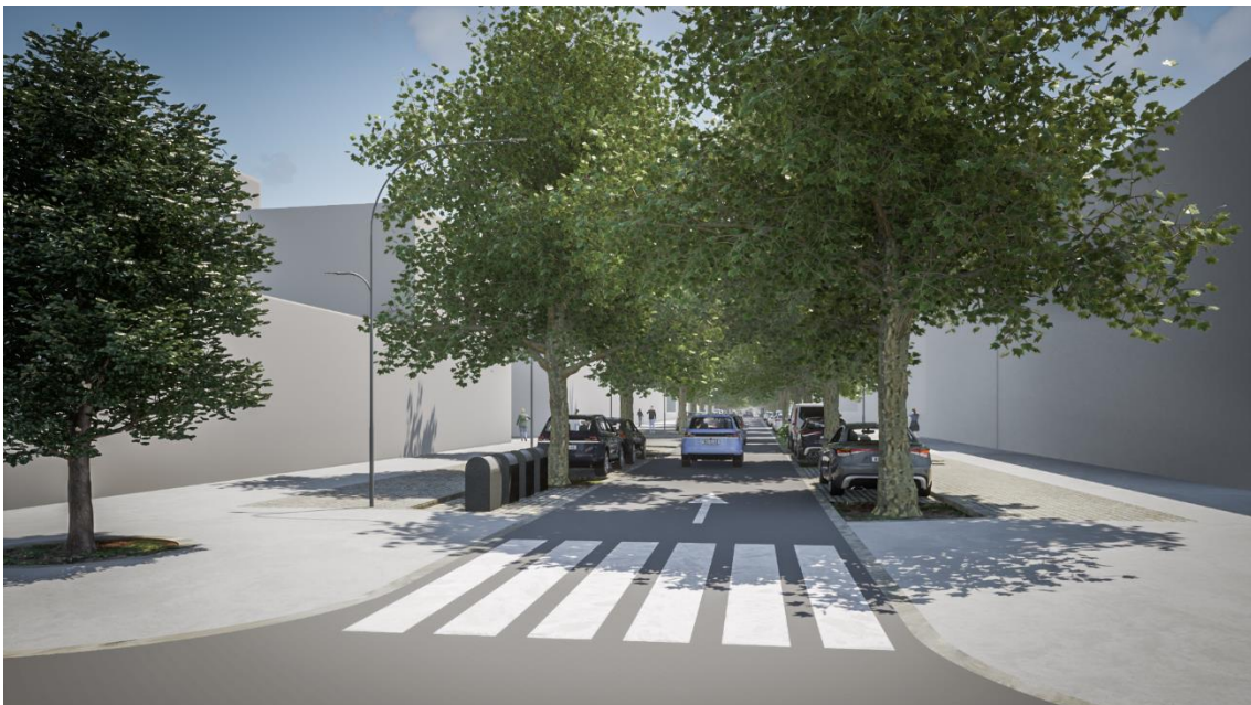
Figura 12.14 - Vista a partir do espaço viário: espaço viário com uma via de trânsito (sentido norte-sul) e zona de estacionamento que tira partido do espaço da arborização; espaço da arborização com alinhamentos laterais de árvores de copa muito larga ( Platanus x acerifolia ), em caldeira; espaço pedonal com bandas de pavimento rugoso e liso (circulação universal).
