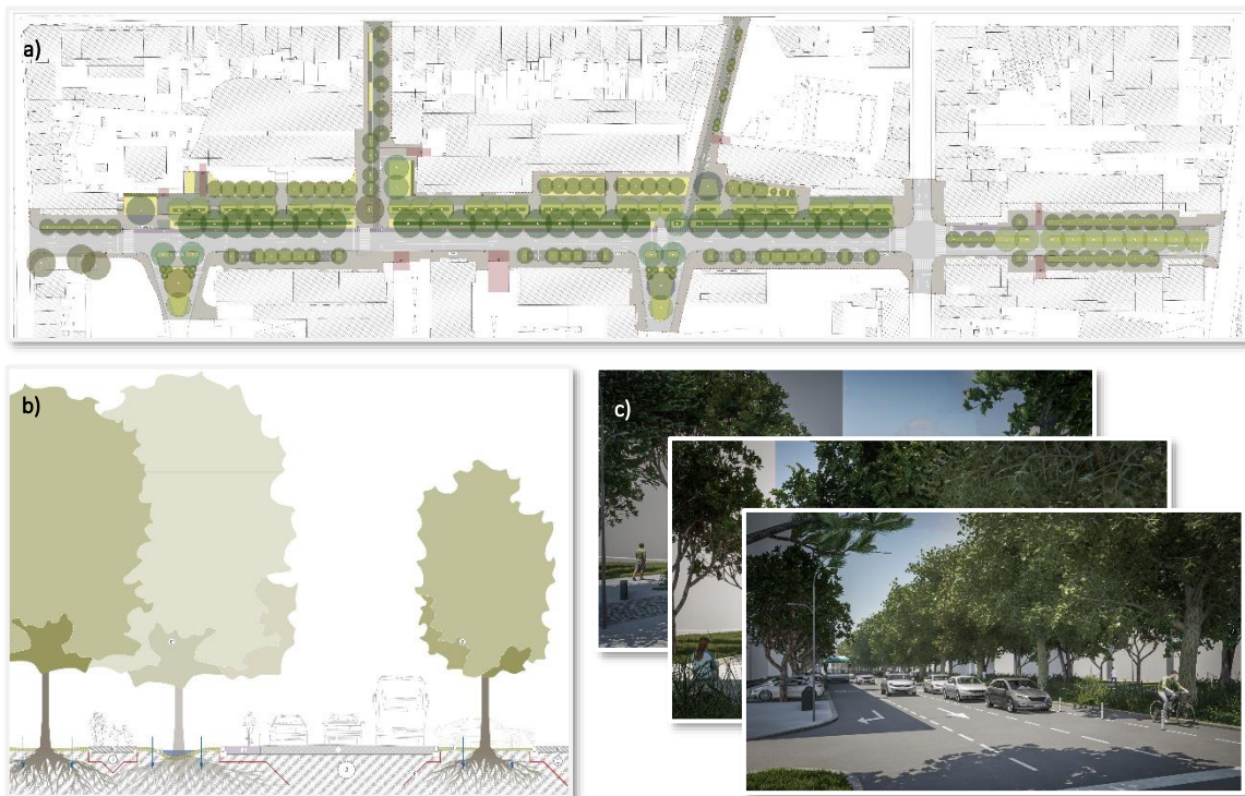
Figura 13.2 – Representação simplificada do conjunto de peças gráficas relativas à proposta de intervenção para a Rua de Damião de Góis: a) planta, b) corte e c) visualizações.
