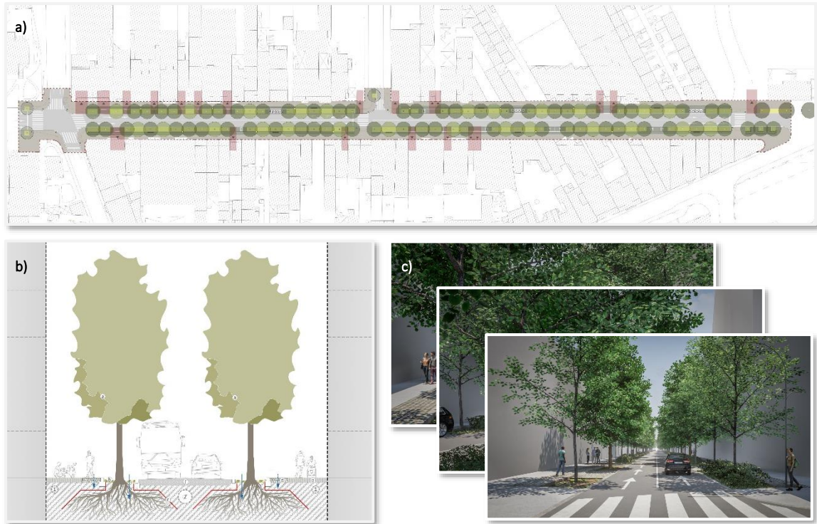
Figura 9.2 – Representação simplificada do conjunto de peças gráficas relativas à proposta de intervenção para a Rua de Cinco de Outubro: a) planta, b) corte, e c) visualizações.
