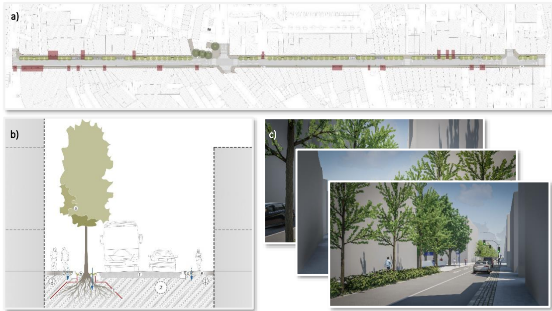
Figura 4.2 – Representação simplificada do conjunto de peças gráficas relativas à proposta de intervenção para a Rua do Heroísmo: a) planta, b) corte, e c) visualizações.
