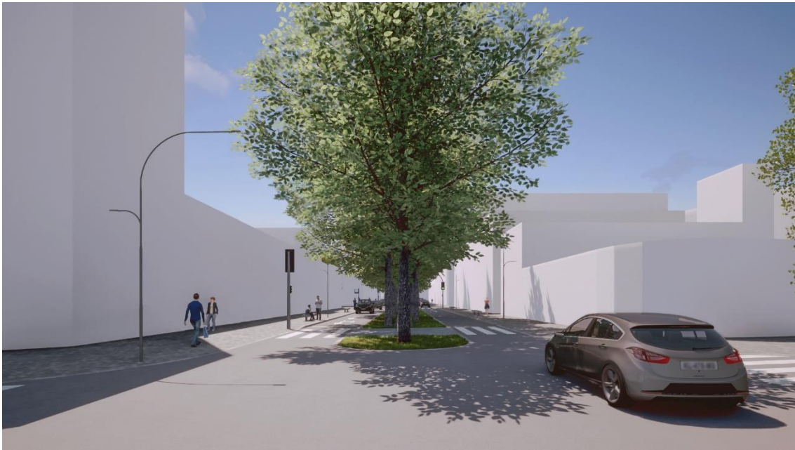
Figura 10.3 - Vista a partir do eixo da rua: espaço da arborização com alinhamento central de árvores de copa muito larga em faixa contínua; espaço viário com uma via de trânsito, de cada lado do espaço da arborização; espaço pedonal com pavimento rugoso.
