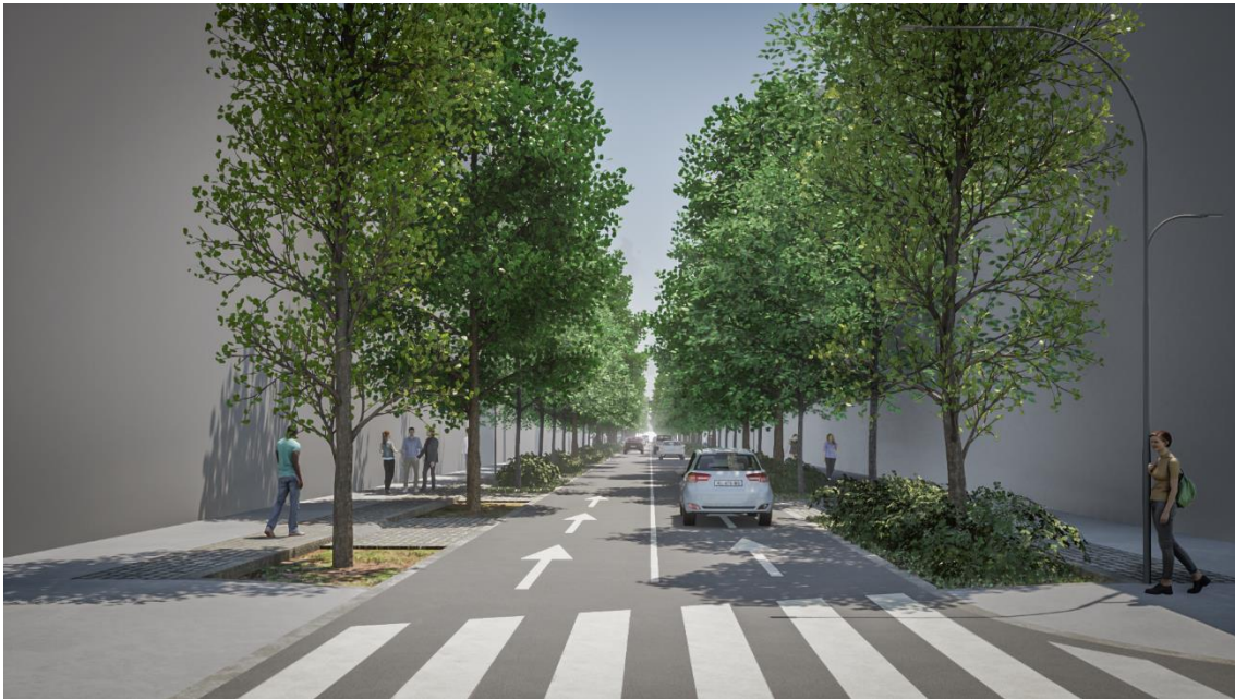
Figura 9.3 - Vista a partir do eixo da rua: espaço viário com duas vias de trânsito (sentido noroeste-sudeste); espaço da arborização com alinhamentos laterais de árvores de copa média-larga em faixa contínua (com bordadura mista de subarbustos e herbáceas vivazes); espaço pedonal com bandas de pavimento rugoso e liso (circulação universal).
