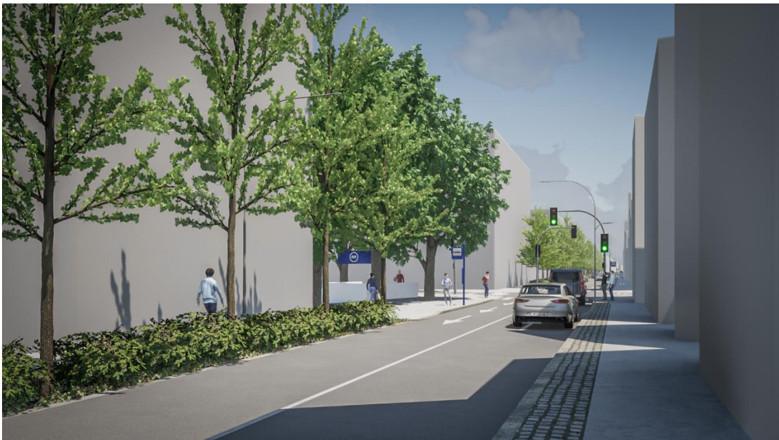
Figura 4.4 - Vista a partir do passeio do lado sul da rua: espaço pedonal com bandas de pavimento rugoso e liso (circulação universal); espaço viário com duas vias de trânsito (dois sentidos); espaço da arborização com alinhamento lateral de árvores de copa estreita em faixa contínua (com bordadura mista de subarbustos e herbáceas vivazes).
