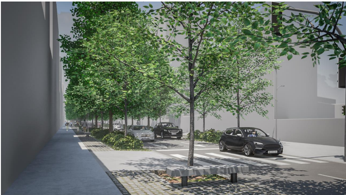
Figura 9.4 - Vista a partir do passeio do lado poente da rua: espaço pedonal com bandas de pavimento rugoso e liso (circulação universal) e zona de estadia/de sentar que tira partido do espaço da arborização; espaço da arborização com alinhamentos laterais de árvores de copa média-larga em faixa contínua (com bordadura mista de subarbustos e herbáceas vivazes); espaço viário com duas vias de trânsito (sentido noroeste-sudeste).
