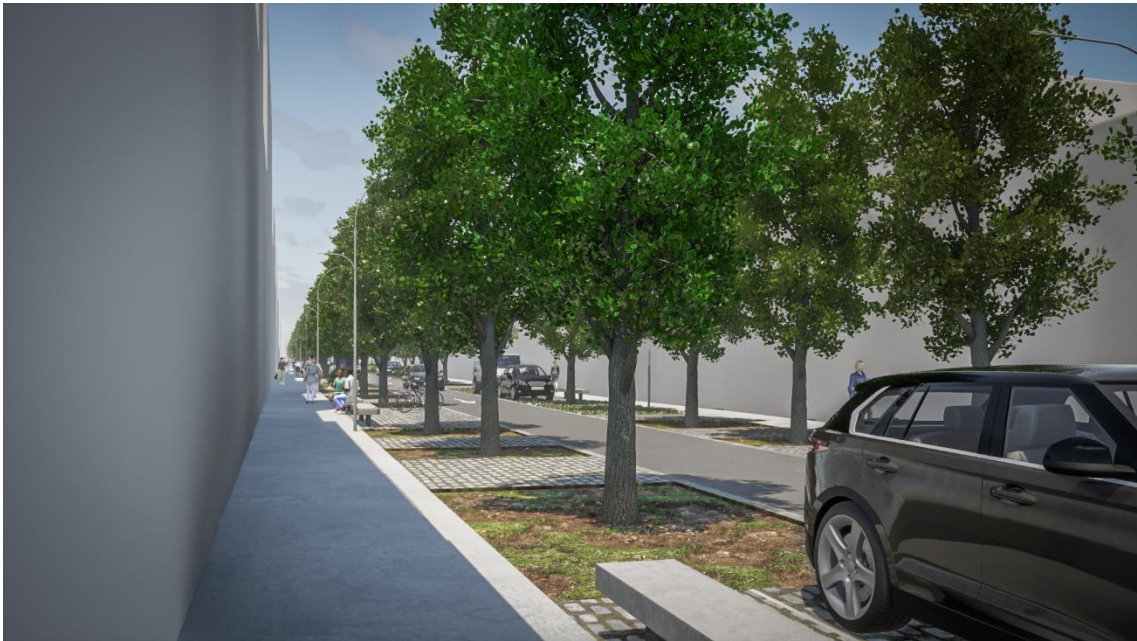
Figura 6.9 - Vista a partir do passeio do lado nascente da rua: espaço pedonal com bandas de pavimento liso (circulação universal) e zona de estadia/ de sentar que tira partido do espaço da arborização; espaço da arborização com alinhamentos laterais de árvores de copa média-estreita em caldeira; espaço viário com uma via de trânsito (sentido norte-sul) e zona de estacionamento que tira partido do espaço da arborização.
