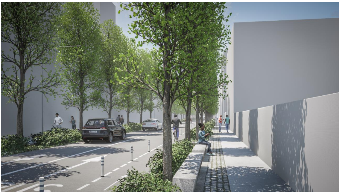
Figura 7.4 - Vista a partir do passeio do lado norte da rua: espaço pedonal com bandas de pavimento rugoso e liso (circulação universal) e zona de estadia/ de sentar; espaço de arborização com alinhamentos laterais de árvores de copa média-estreita em faixa contínua (com bordadura mista de subarbustos e herbáceas vivazes); espaço viário com duas vias de trânsito e uma ciclovia (sentido nascente-poente).
