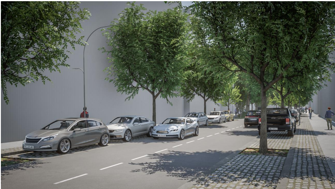
Figura 8.9 - Vista do passeio do lado poente da rua: espaço pedonal com bandas de pavimento rugoso e liso (circulação universal); espaço da arborização com alinhamentos laterais de árvores de copa média-estreita em caldeiras; espaço viário com duas vias de trânsito (dois sentidos) e zona de estacionamento que tira partido do espaço da arborização.
