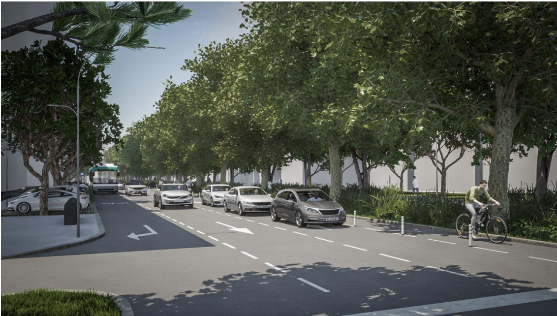
Figura 13.3 - Vista a partir do passeio do lado sul da rua (secção ocidental): espaço pedonal com pavimento liso (circulação universal); espaço da arborização com alinhamentos laterais de árvores de copa média-larga em caldeira, alinhamento central-duplo de árvores de copa muito larga e árvores de copa larga em faixa contínua (com bordadura mista de subarbustos e herbáceas vivazes); espaço viário com duas vias de trânsito geral, uma via de transportes coletivos e uma ciclovia (sentido poente-nascente).
