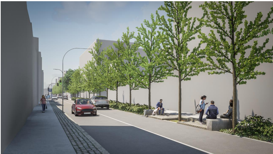
Figura 4.6 - Vista a partir do passeio do lado sul da rua: espaço pedonal com bandas de pavimento rugoso e liso (circulação universal) e zona de estadia/ de sentar que tira partido do espaço da arborização; espaço viário com duas vias de trânsito (dois sentidos); espaço da arborização com alinhamento lateral de árvores de copa estreita em faixa contínua (com bordadura mista de subarbustos e herbáceas vivazes).
