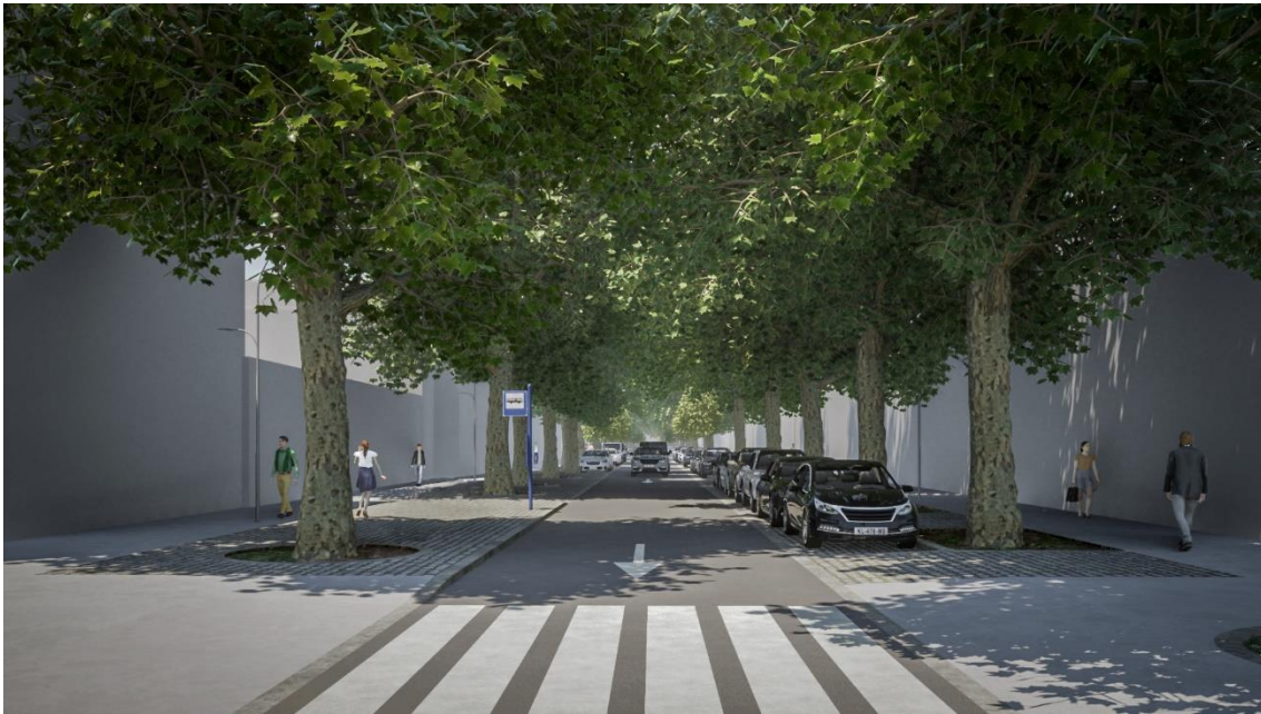
Figura 12.7 - Vista a partir do eixo da rua: espaço viário com uma via de trânsito (sentido norte-sul) e zona de estacionamento que tira partido do espaço da arborização; espaço da arborização com alinhamentos laterais de árvores de copa muito larga, propostas e existentes ( Platanus x acerifolia ), em caldeira; espaço pedonal com bandas de pavimento rugoso e liso (circulação universal).
