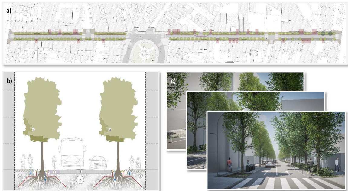
Figura 7.2 - Representação simplificada do conjunto de peças gráficas relativas à proposta de intervenção para a Rua da Constituição: a) planta, b) corte, e c) visualizações.
