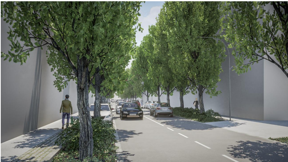
Figura 5.10 - Vista a partir do espaço da arborização do lado nascente da rua: espaço da arborização com alinhamentos laterais de árvores de copa média-estreita em faixa contínua (com bordadura mista de subarbustos e herbáceas vivazes); espaço viário com duas vias de trânsito (dois sentidos) e zona de estacionamento que tira partido do espaço da arborização; espaço pedonal com bandas de pavimento rugoso e liso (circulação universal).
