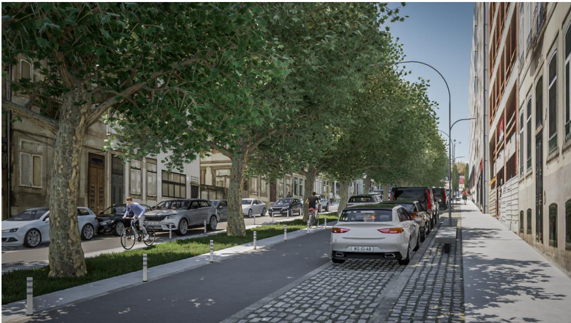
Figura 11.5 - Vista a partir do passeio do lado nascente da rua: espaço pedonal com bandas de pavimento rugoso e liso (circulação universal) e zona de estadia/ de sentar; espaço viário com uma via de trânsito, ciclovia e zona de estacionamento, de cada lado do espaço da arborização; espaço da arborização com alinhamento central de árvores de copa muito larga, em faixa contínua.
