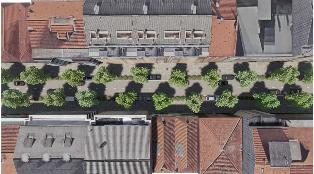
Figura 5.15 – Exemplo de aplicação do modelo 4 numa rua com 17,20m, com alinhamento bilateral de árvores de copa média-estreita, do tipo carvalho-alvarinho de copa estreita ( Quercus robur 'Fastigiata'), liquidâmbar de copa estreita ( Liquidambar styraciflua 'Fastigiata') ou castanheiro-da-Índia de copa estreita ( Aesculus hippocastanum 'Fastigiata'): vista de topo (visualização realista).
